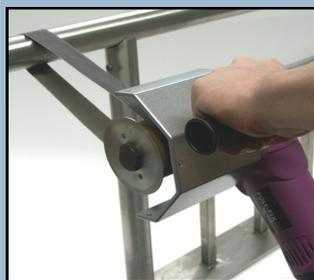
Preparación del pulido del tubo con las bandas de piramidal y el rodillo para bandas con flancos VA.
