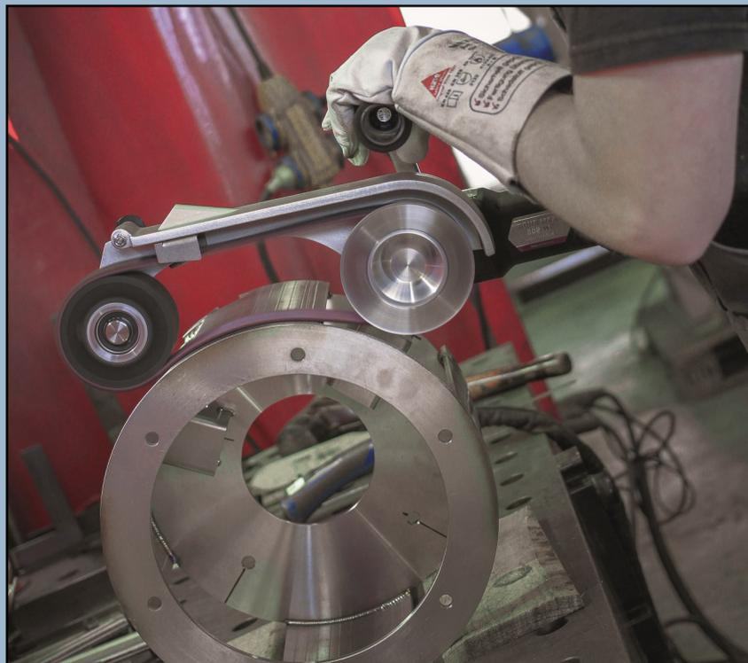
Con nuevo eje planetario, que evita la sobrecarga de los engranajes y de la electrónica
